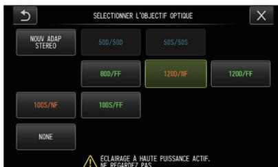
Sélectionner l'adaptateur optique à utiliser et appuyer sur le joystick [MEAS/OK].
