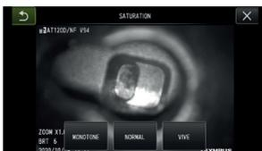
Appuyer sur le bouton pour modifier le niveau de saturation.
