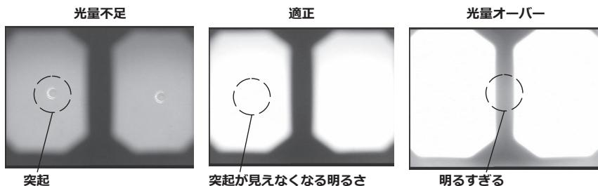
検具の白色凹部に汚れが付着していると適切な白画像が撮影できないことがあります。その場合には、白色凹部に取り付けられている直視および側視ガイド穴がある部品（ガイド）を取り外して、汚れを除去してください。
