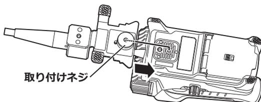
スコープユニットの三脚取り付け穴にガイドチューブの取り付けネジを確実に締め込み、ガイドチューブにガタつきが無いことを確認する
