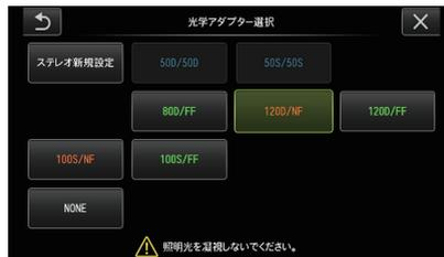
使用する光学アダプターを選択して、[MEAS/OK] ジョイスティックを押します。
