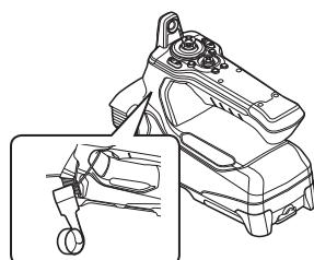
挿入部をループ状に巻いて、スコープユニットの折れ止め付近で挿入部固定ベルトを使って束ねます。
