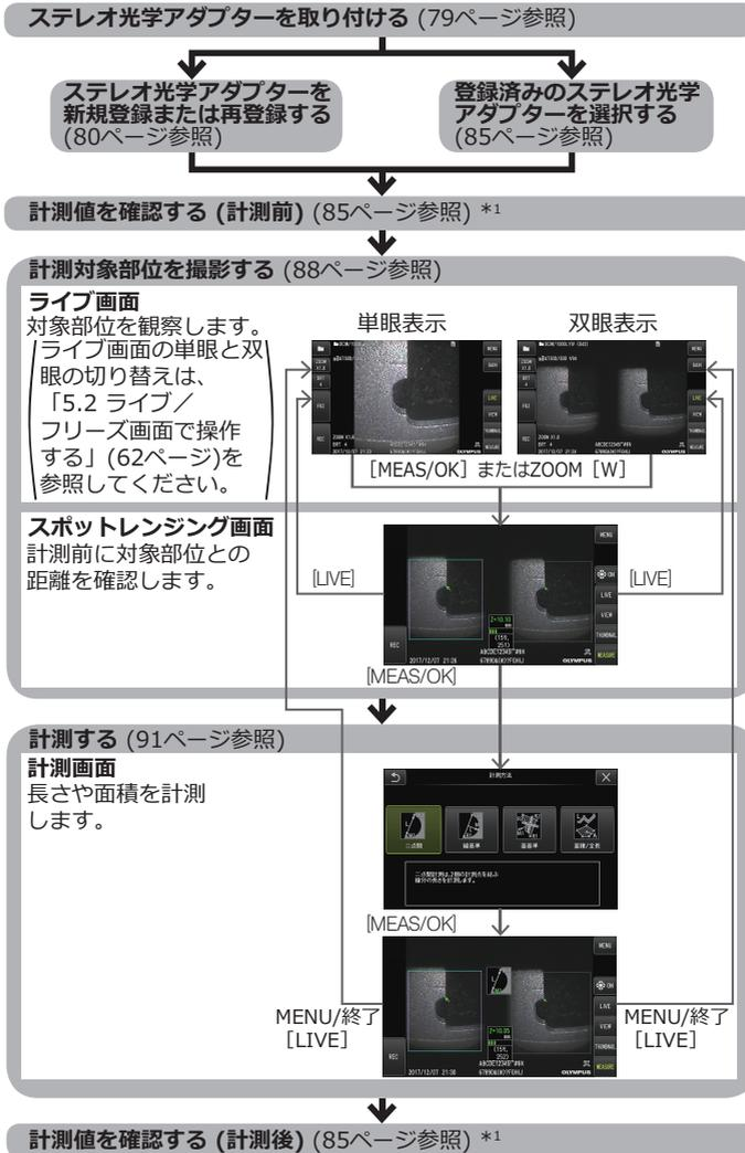
\*1 「計測値を確認する(計測前)」と「計測値を確認する(計測後)」で得られた計測値がほぼ同じであることを確認してください。計測値に違いがある場合は、ステレオ光学アダプターの緩みやレンズの汚れを点検し、必要に応じて再度計測してください。
