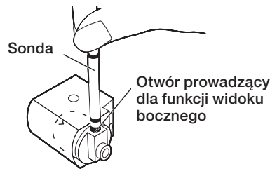
Adapter optyczny stereo z polem widzenia skierowanym w bok
