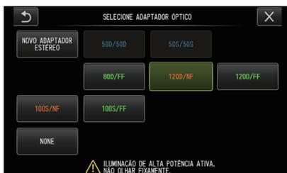
Selecionar o adaptador ótico a utilizar e pressionar o joystick [MEAS/OK].
