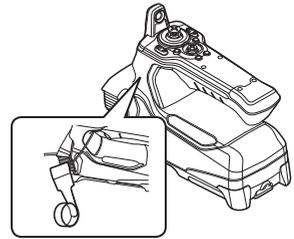
盘绕插入管，并使用紧固带将其捆绑在内窥镜的弯曲限位器附近。
