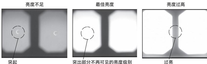
如果灰尘附着在检查工具的白色凹陷部分，则无法捕捉到最佳的白色图像。如果发现污垢，请从白色凹陷部分拆下带有直视图或侧视图导孔的部件（导向器），并清除污垢。要取下导向器，请沿逆时针方向转动导板。使用用清水沾湿的纱布擦去污垢。要重新安装导向器，请按照与卸下步骤相反的顺序进行。
