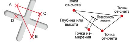
Режим ГЛУБИНА/ВЫСОТА служит для измерения расстояния от указанной точки до плоскости, определенной тремя точками.
