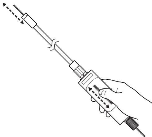
**3** Pour bloquer le tube d'insertion dans une position fixe, serrer le mandrin.
