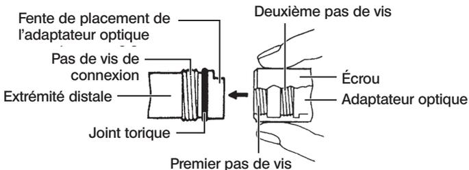
**2** Tourner l'écrou de l'adaptateur optique dans le sens des aiguilles d'une montre jusqu'à ce que le filetage de la vis passe sur le premier filetage.
