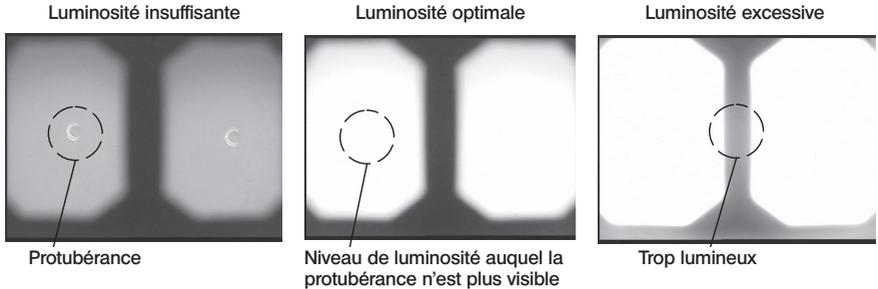
Il n'est pas possible de capturer une image blanche optimale s'il y a de la saleté sur la partie renfoncée blanche de l'outil de vérification. S'il y a de la saleté, détacher la partie (guide) contenant l'orifice du guide de la vue avant ou de la vue latérale de la partie renfoncée blanche et éliminer la saleté.
