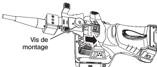
Serrer fermement la vis de montage du tube de guidage sur l'orifice de montage du trépied de cette unité puis vérifier que le tube de guidage est correctement fixé.
