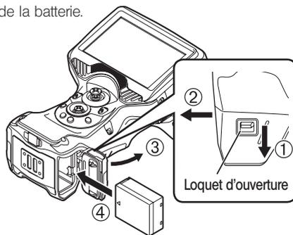
Vérifier que le couvercle du compartiment de la batterie est verrouillé.
