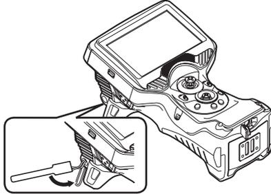
Enrouler le tube d'insertion et l'attacher à l'aide de la sangle d'attache située à proximité du dispositif anti-torsion du corps de l'endoscope. Tenir le corps de l'endoscope lors du déplacement de l'unité.
