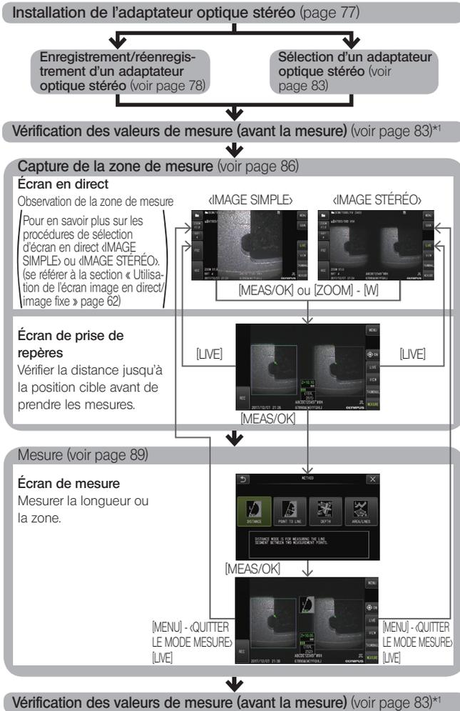
\*1 S'assurer que les valeurs de mesure obtenues lors de la « Vérification des valeurs de mesure (avant la mesure) » et la « Vérification des valeurs de mesure (après la mesure) » sont presque identiques. Si les valeurs de mesure diffèrent l'une de l'autre, vérifier que l'adaptateur optique stéréo n'est pas desserré et que l'objectif n'est pas sale, et effectuer de nouveau la mesure si nécessaire.
