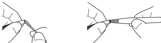
**Отложения грязи на установочной канавке оптического объектива или винтовой резьбе дистального конца**
