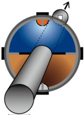
중력 방향 아이 은 삽입 튜브의 말단부가 삽입되는 방향에 대비하여 수직으로 절단된 면을 표현합니다. 갈색 영역은 지면 (중력 방향)을 나 내고 파란색 영역은 하늘 (중력에 반대되는 방향)을 나 냅니다.
