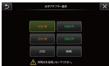
使用する光学アダプターを選択して、[MEAS/ENTER]ジョイスティックを押します。
