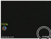
検査対象物への挿入中にガイドヘッドが挿入部先端から外れかけると視野の一部が欠けます。
