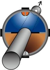
重力方向アイコンは挿入部先端部の進行方向に対して垂直にカットした面を表現しており、茶色の領域が地面側(重力方向)、青色の領域が空側(重力と反対方向)を示しています。
