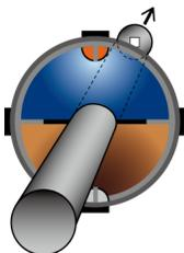
Значок направления действия силы тяжести указывает на поверхность, являющуюся вертикальным срезом относительно направления введения дистального конца зонда. Коричневая область обозначает сторону земли (направление действия силы тяжести), а синяя — сторону неба (направление, обратное действию силы тяжести).
