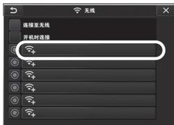
3 在接入点设置窗口出现时，输入“SSID”和“密码”。然后，选择 [加密方法] 并选择 [登录]。
