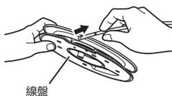
從主機的線盤盒中取下線盤，然後從線盤中取出插管。
