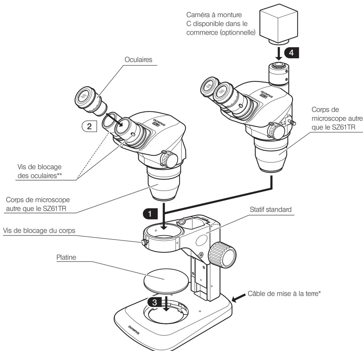
\* Pour garantir l'efficacité du système de protection ESD, veiller à mettre correctement l'équipement à la terre au moyen d'un câble de mise à la terre équipé d'une fiche-banane 4 mm.
