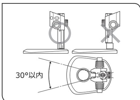
**注意** 転倒防止上、必ず図の○印のように取り付け、左右の振れ角度は30°以内としてください。後ろ向きに取り付けると転倒します。
