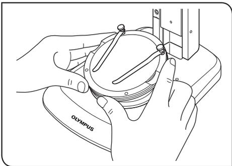
**1** 試料をステージ板の上のせて、カップステージの縁を手で持ち、カップステージをゆっくりと傾斜させます。
