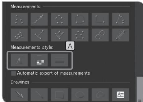
Si possono modificare le linee e i testi (valori di misurazione) dei risultati di misurazione utilizzando colori, spessori e font a scelta.
