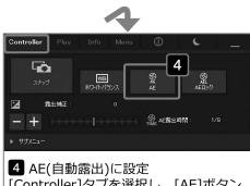
4 AE(自動露出)に設定 [Controller]タブを選択し、[AE]ボタン を押して、ボタンが青色の状態にしま す。
