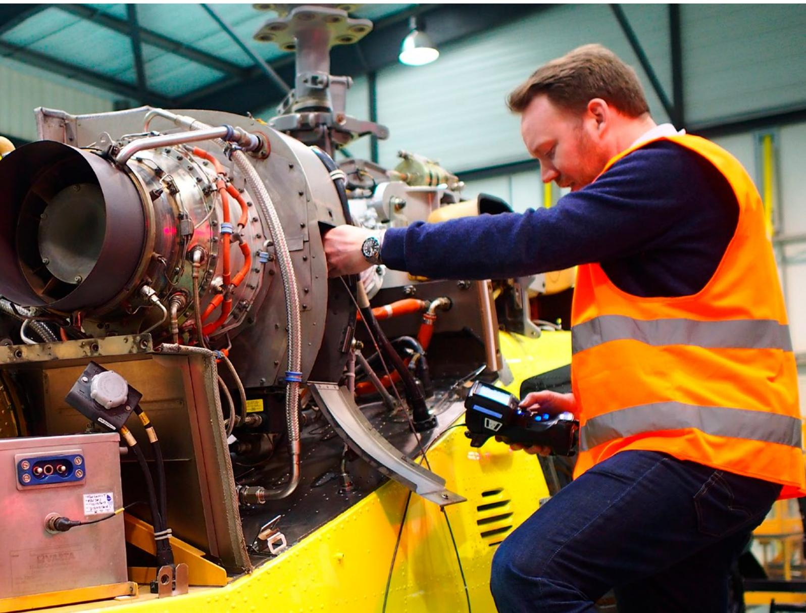
常规的内窥检测对于飞机的安全飞行至关重要。我们的手持式套装包含超便携型IPLEXG Lite视频内窥镜和其他一些推荐使用的工具，可对直升机、小型飞机及其发动机进行快速、高效地检测。
