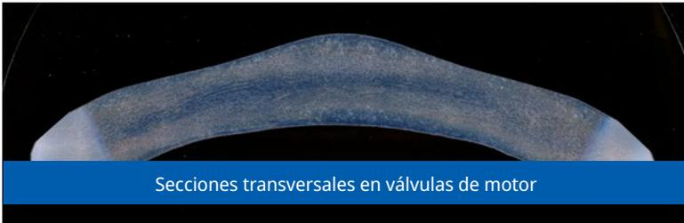
Secciones transversales en válvulas de motor
