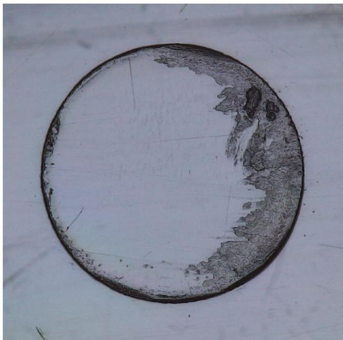
偏光:根据样品的偏光特性,可通过对比度和颜色确认各部分的应力。
