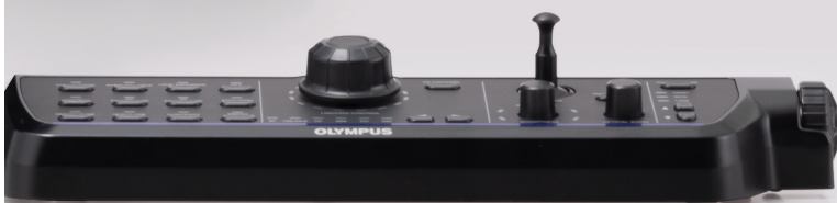
Console de commande à distance facilitant le contrôle du système
