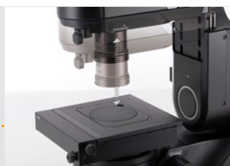
Rychlý posun hlavy zoomu lze provádět nastavením otočného ovladače jemného ostření
