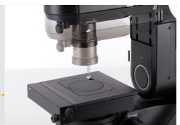
Desplazamiento rápido del cabezal de zoom mediante el ajuste de la perilla micrométrica
