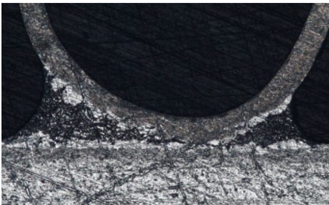
Il campione è sfuocato quando si usa un obiettivo convenzionale (1700X)
