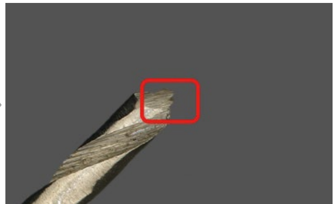
Объектив DSX1000 (24X): четкая видимость поврежденной зоны, благодаря плоскому освещению
