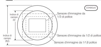
A titolo informativo, il seguente grafico mostra le aree del campo di acquisizione a seconda del campo visivo degli oculari con indice di campo 22 o 26,5 e della misura del sensore d'immagine attraverso l'adattatore TV a passo C.
