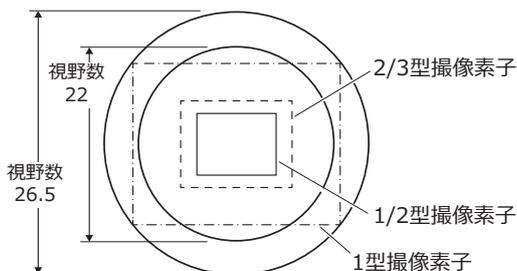
**参考** 視野数22または視野数26.5の接眼レンズ使用時の視野と、Cマウントカメラアダプターを介した撮像素子の大きさによる撮像視野の範囲を示します。
