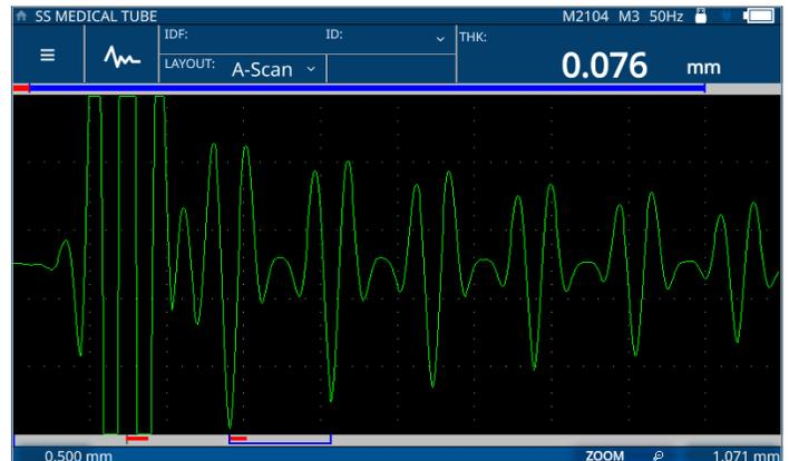
Mediciones de espesor precisas en materiales finos para optimizar el control de calidad.
