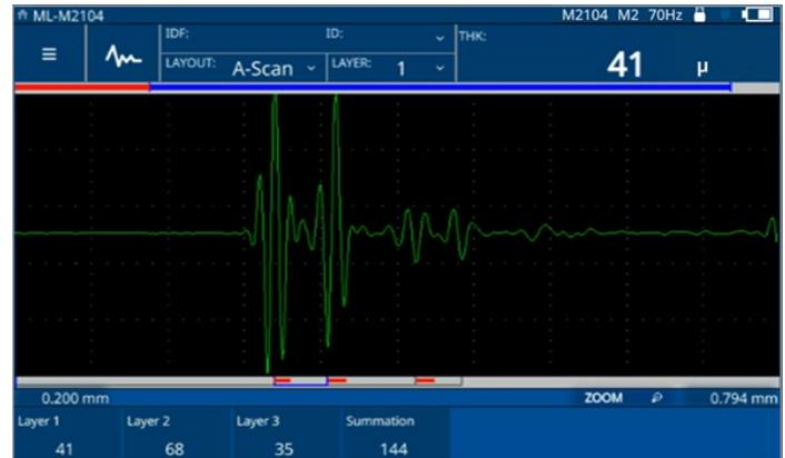
複合材の多層コーティングに対する測定の正確さと再現性
