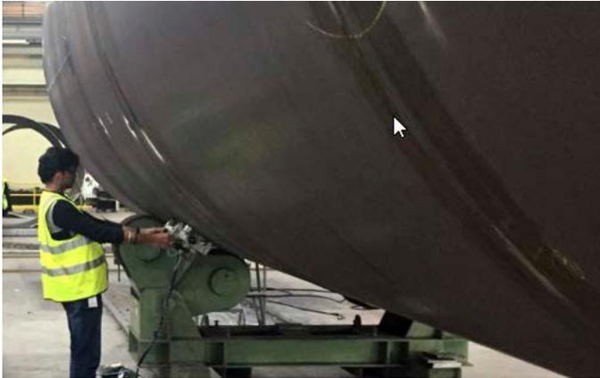
Utilisée à la place de la radiographie (RT), notre solution perfectionnée d'inspection par ultrasons multiéléments (PA) utilisant le logiciel WeldSight améliore l'efficacité de l'inspection des soudures de tuyaux et de réservoirs conformément aux normes ASME, ISO et autres normes de fabrication similaires. Inspectez les matériaux austénitiques, y compris les tuyaux revêtus et les soudures en métaux dissemblables, à l'aide de nos sondes à ultrasons multiéléments 1D, TOFD et DLA/DMA.
