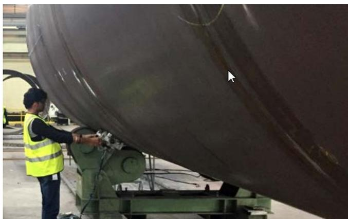
ASME や ISO などの製造規格に準拠するパイプおよび圧力容器の溶接部検査では、放射線検査 (RT) の代わりに、WeldSight ソフトウェアを含む当社の先進のフェーズドアレイ (PA) 探傷ソリューションを用いると、効率が上がります。当社の 1D フェーズドアレイプローブ、TOFD、および DLA/DMA フェーズドアレイプローブを使用して、クラッドパイプなどのオーステナイト材や異種金属間溶接部を検査します。
