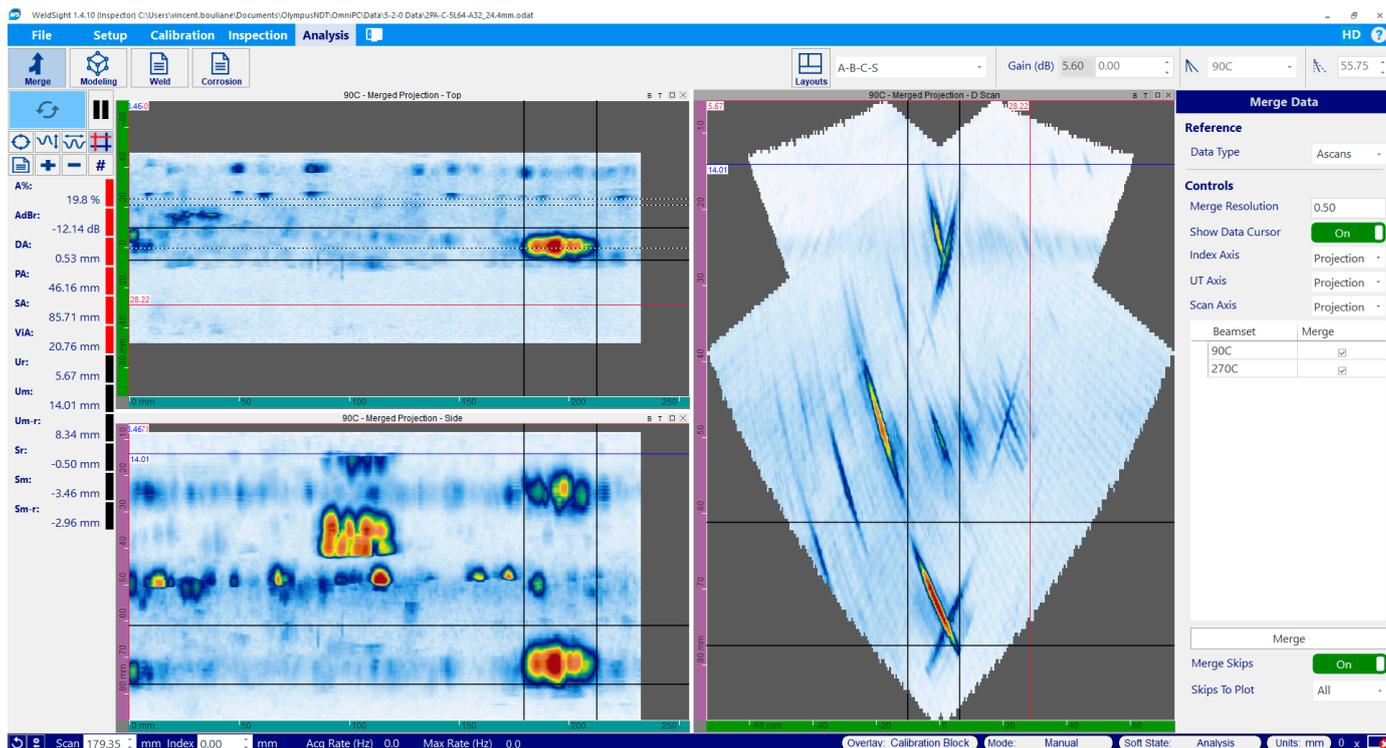
WeldSight软件的众多分析工具可使您以多种方式进行检测目标,从而可以准确地表征、定位和定量缺陷。
