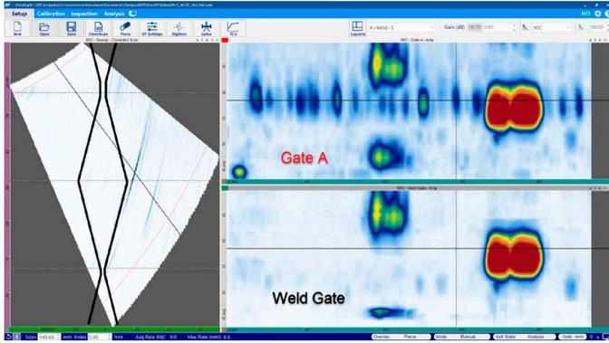
数据的显示方式可使您更深入地了解风塔焊缝的情况,而且符合特定程序、应用或规范的要求,包括对复杂几何形状的检测。
