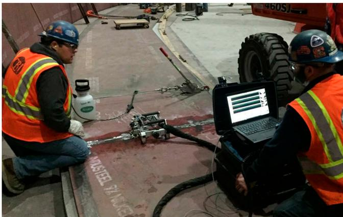
使用奥林巴斯完整的PA解决方案进行液化天然气 (LNG) 储罐检测，符合API和类似的制造规范。与RT或UT系统相比，WeldSight软件不仅可提高生产力，还可进行实时分析。使用我们的DLA探头可以检测低温储罐典型的奥氏体9%镍壳和I625异种金属焊缝。
