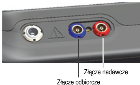
Rysunek 2-2 Złącza LEMO oznaczone kolorami
