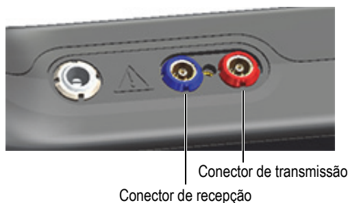
Figura 2-2 Conectores LEMO com código de cores
