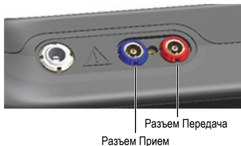
Рис. 2-2 Разъемы LEMO с цветовой кодировкой
