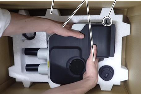
Meta los dedos en la sección cóncava para sacar el tubo de trinocular de inclinación AR **F** en la protección inferior **H**.
