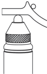
Abbildung 4-15 Falsche Messmethode, da die Messkugel blockiert ist
