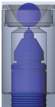
**Figura 4-7 Alineación del disco plano con el canto de la punta de tipo cincel**
