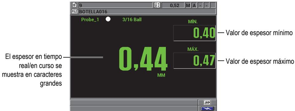
**Figura 5-3 Visualización de los valores de espesor mínimo y máximo**
