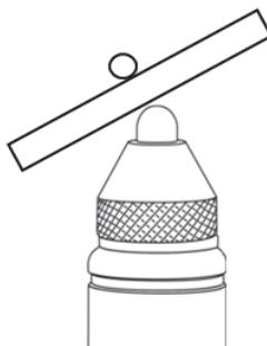
**Figura 4-17** Medidas inexactas debido al mal alineamiento de la sonda
