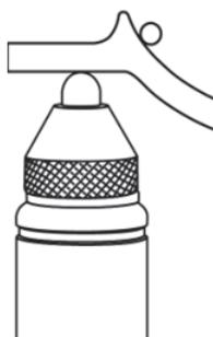
**Figura 4-15 Medidas inexactas debido a una obstrucción en el área del accesorio auxiliar**
