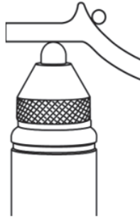
図 4-15 不正確な厚さ測定の場合： ターゲットボールが障害物により正しく接触していない
