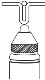
図 4-16 不正確な厚さ測定の場合： ターゲットボールが湾曲により正しく接触していない
