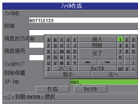
図 7-3 インクリメンタルファイルタイプのためのファイル作成画面
