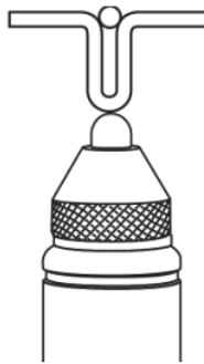
Figura 4-15 Medição imprecisa devido à curvatura da superfície
