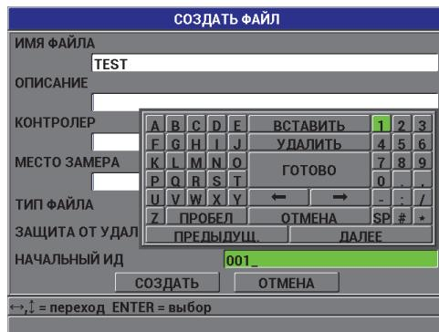
Рис. 7-3 Экран СОЗДАТЬ ФАЙЛ для инкрементного типа файла
