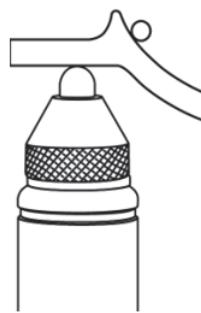
Рис. 4-15 Неправильное измерение. Шарик заблокирован
