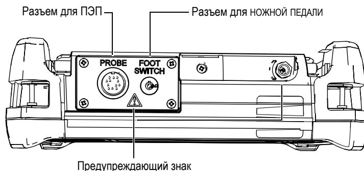
Рис. 1-18 Расположение разъемов PROBE и FOOT SWITCH
