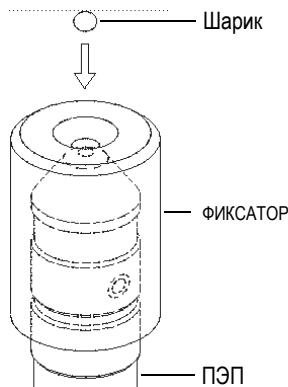
**Рис. 4-6 Центрирование шарика в фиксаторе на ПЭП**
