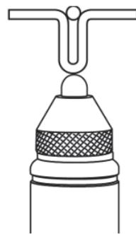
Рис. 4-16 Неправильное измерение. Кривизна поверхности
