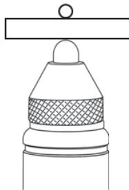
Рис. 4-13 Правильный метод измерения толщины
