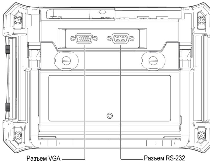
**Рис. 1-19 Разъемы RS-232 и VGA**
