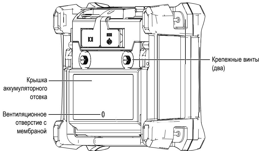
Рис. 1-21 Аккумуляторный отсек
