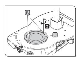
**2** 六角レンチを使って、ねじ(2個) Bを架台のねじ穴(2カ所)に固定して、SZX2-STADM(ILLT用STADマウント) Cを架台に取り付けます。
