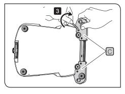
3 六角レンチを使って、ねじ(4個)を架台の後部にあるねじ穴(4カ所)に固定して、SZX2-ILLTSA(ILLT用高安定化アダプター) を取り付けます。
