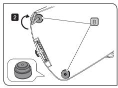
2 ゴム足(2個) Aの取り付けに使用していたねじ穴(2カ所)に、六角レンチを使って同梱品のゴム足(2個) Bに付いているねじを固定して、同梱品のゴム足(2個) Bを取り付けます。
