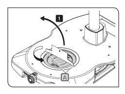
1 ステージガラス枠の切り欠きAにステージガラス枠用ドライバーをはめ込んで、反時計回りに回して、ステージガラスを取り外します。
