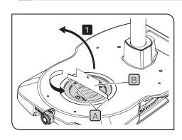
1 ステージガラス枠の切り欠きAに架台に同梱されているステージガラス枠用ドライバーBをはめ込んで、反時計回りに回して、ステージガラスを取り外します。
