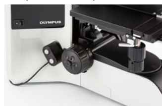
Sistema di regolazione per la rotazione del revolver motorizzato
