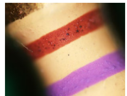
部分的に点灯したリング照明をさまざまな角度からサンプルに照射。それぞれの記録画像の良好な箇所をPRECiVで合成することで、照明の写りこみを効果的に除去
