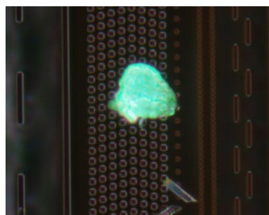
MIX: 蛍光+暗視野照明 対象物が鮮明でサンプル内の位置も容易に特定できる
