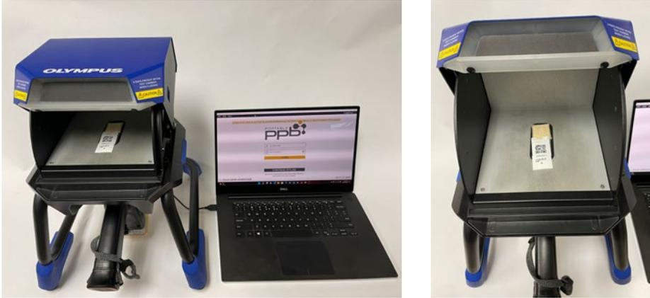
그림 1: PPPB pLIMS 소프트웨어를 사용하여 Vanta 워크스테이션에서 detectORE™ 수집기 장치 분석.
