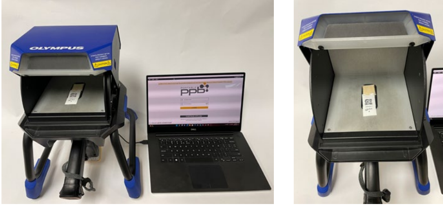
图1: 在Vanta工作站中使用Portable PPB的pLIMS软件对detectORE收集器进行分析。
