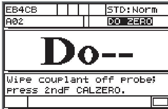
Obrázek 5-2 Obrazovka Do-- pro neznámou rychlost šíření zvuku v materiálu
