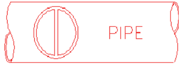
Obrázek 10-1 Kolmé zarovnání ke středu osy trubky
