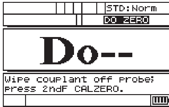
Figura 4-1 Compensazione dello zero del trasduttore
