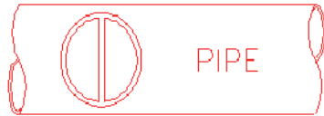
Figura 10-1 Allineamento perpendicolare al centro dell'asse sulla tubazione
