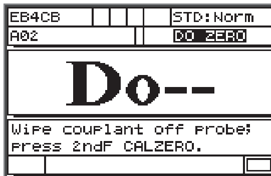
Figura 5-2 La schermata Do-- della non nota velocità di propagazione dell'onda sonora nel materiale
