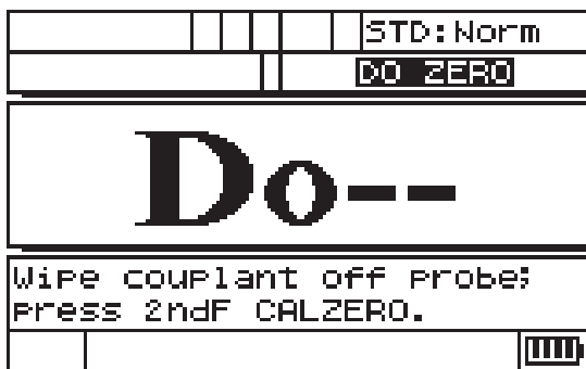
図 4-1 探触子のゼロ校正
