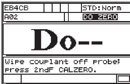
図 5-2 材料音速が不明な場合の Do-- 画面
