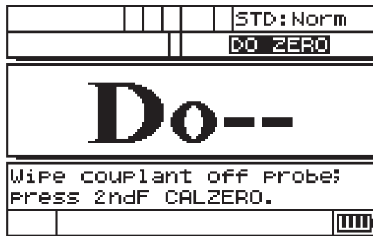
Rys. 4-1 Kompensacja zera głowicy
