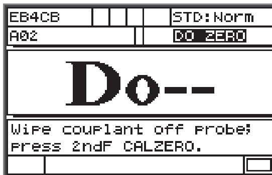
Rys. 5-2 Ekran Do-- dla nieznannej prędkości dźwięku w materiale
